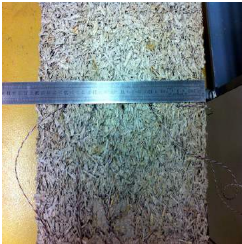
Bloc de chanvre instrumenté
